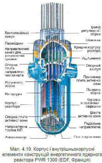
Рис. 26.3. Схема будови ядерного реактора
