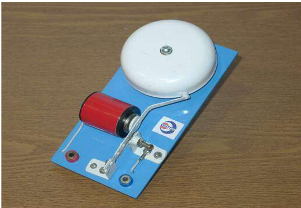
Електричний дзвінок із електромагнітом.
